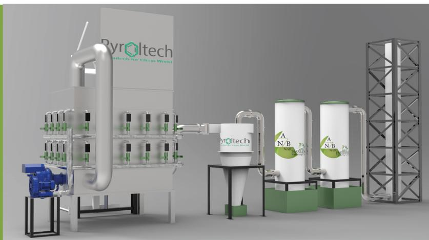
بنابراین تمام ترکیبات سمی (مانند دی اکسین) تا حد بسیار زیادی تخریب شده و از بین می‌روند. در ادامه برای جلوگیری از تشکیل سایر ترکیبات سمی دیگر، دما سریعاً تا حد زیادی کاهش یابد، لذا ازهای خروجی از محفظه ثانویه وارد سیستم خنک کننده شده و دما در مدت زمان ۱ ثانیه تا حدود زیادی کاهش می‌یابد.
